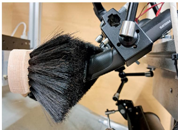
**Bürstenschnitt.** Im Lebensdauertest arbeitet sich jeder Bartrimmer 40 Stunden lang vollautomatisch an Naturhaarbesen ab.
