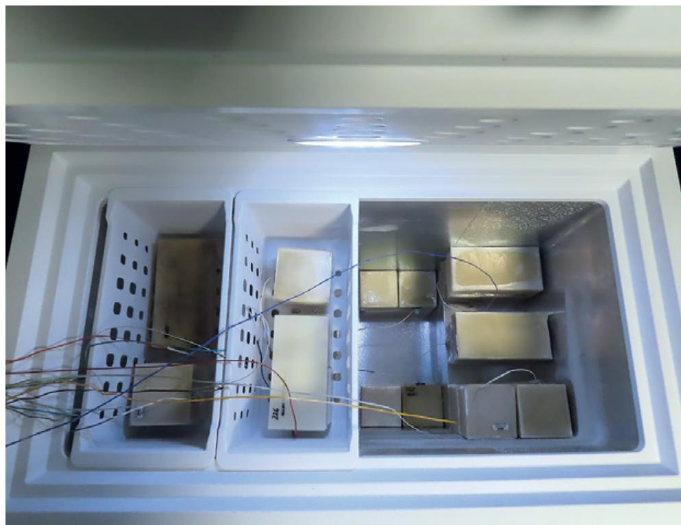
**Verkabelt.** Die mit Sensoren bestückten Gelee-Pakete simulieren Fleisch. Mit ihnen messen wir im Test, wie schnell die Geräte Gefriergut durchfrosten.
