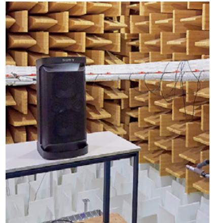
Klangprüfung. Kunststoffkeile fangen Geräusche im Prüfraum ab.
