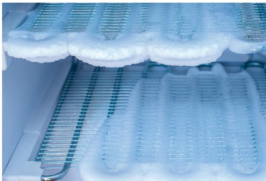
**Zu viel Eis auf den Rippen.** Höchste Zeit abzutauen, denn unter der Eisschicht funktioniert der Kühlkreislauf ineffizient.
