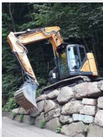
CX145DSR Einsatzgewicht 14.500 kg Leistung 78,5 kW
