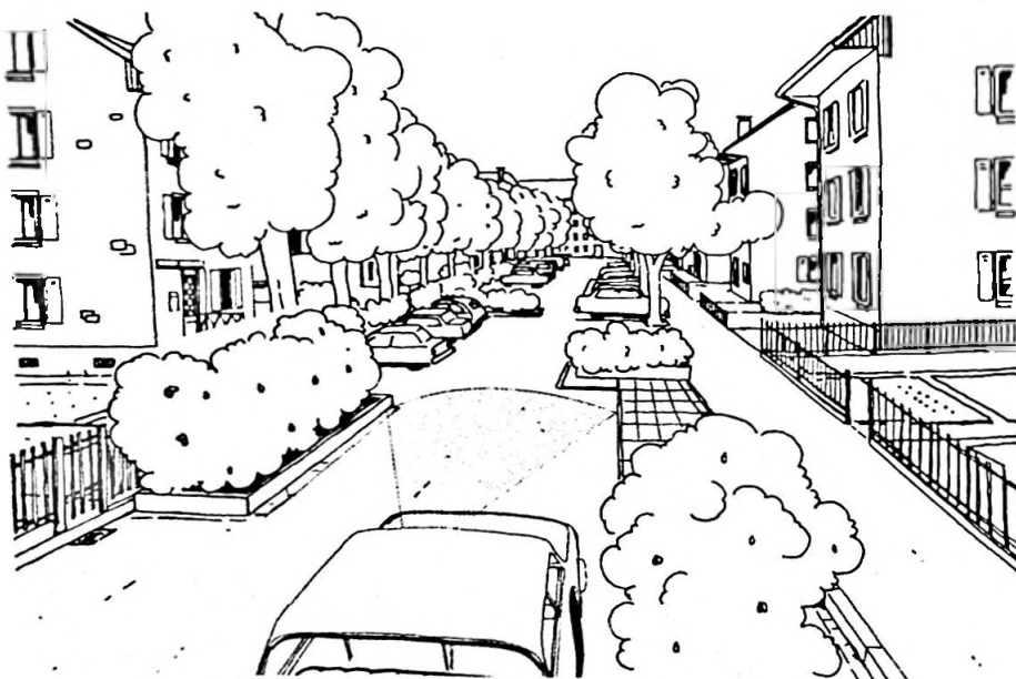
Abb. 13 : Horizontale Fahrbahnversätze verkürzen das Blickfeld des Autofahrers und bewirken dadurch eine langsamere Fahrweise
