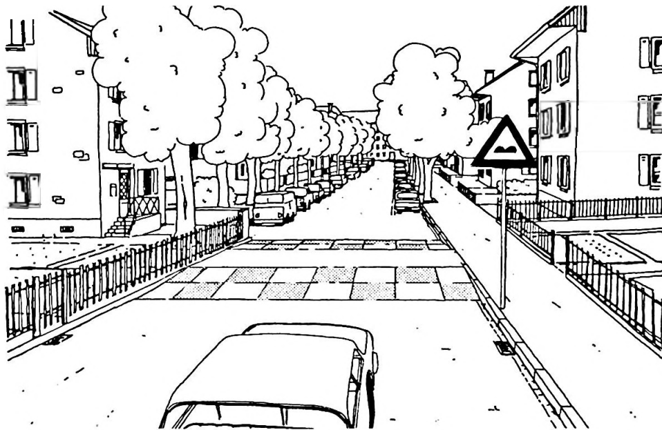
Abb. 14 : Vertikale Fahrbahnversätze (Aufpflasterungen) können mit mässiger Geschwindigkeit gefahrlos befahren werden
