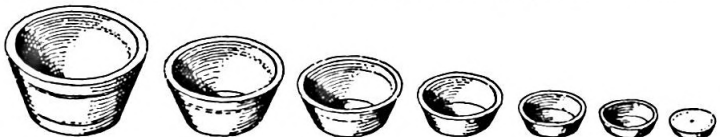
Abb. 54 Gewichtssatz aus Messing, \frac{1}{2} Schw. Pfund (250 g) = 16 Lot Gehäuse = 8 Lot, Einsätze zu 4, 2, 1, \frac{1}{2} , \frac{1}{4} , \frac{1}{8} , \frac{1}{16} Lot, total = 16 Lot
