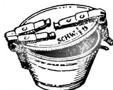
Abb. 54 Gewichtssatz aus Messing, \frac{1}{2} Schw. Pfund (250 g) = 16 Lot Gehäuse = 8 Lot, Einsätze zu 4, 2, 1, \frac{1}{2} , \frac{1}{4} , \frac{1}{8} , \frac{1}{16} Lot, total = 16 Lot
