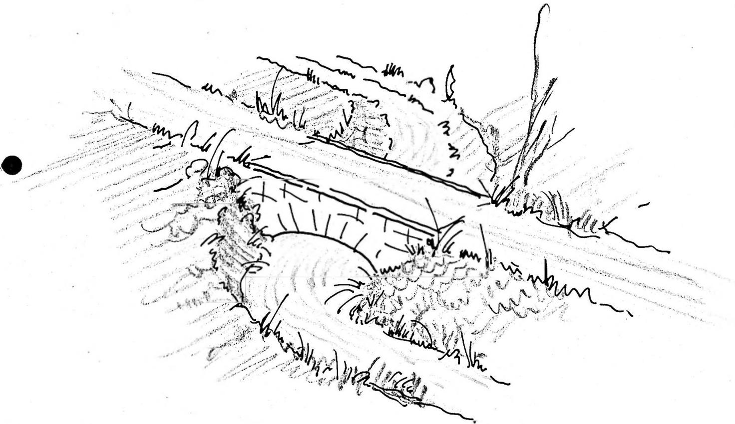
Da wo heute der Bach durch ein Zementrohr von einer Seite auf die andere Seite des Hauptweges geschleust wird, soll eine sinnvollere Anlage erstellt werden. Geeignet ist eine aus Natursteinen handwerklich gemauerte Ueberdeckung mit breitem Wasserdurchlass. Der Bach muss in normaler Breite vollständig sichtbar unter dem Brüggli hindurch seinen natürlichen Lauf haben.
