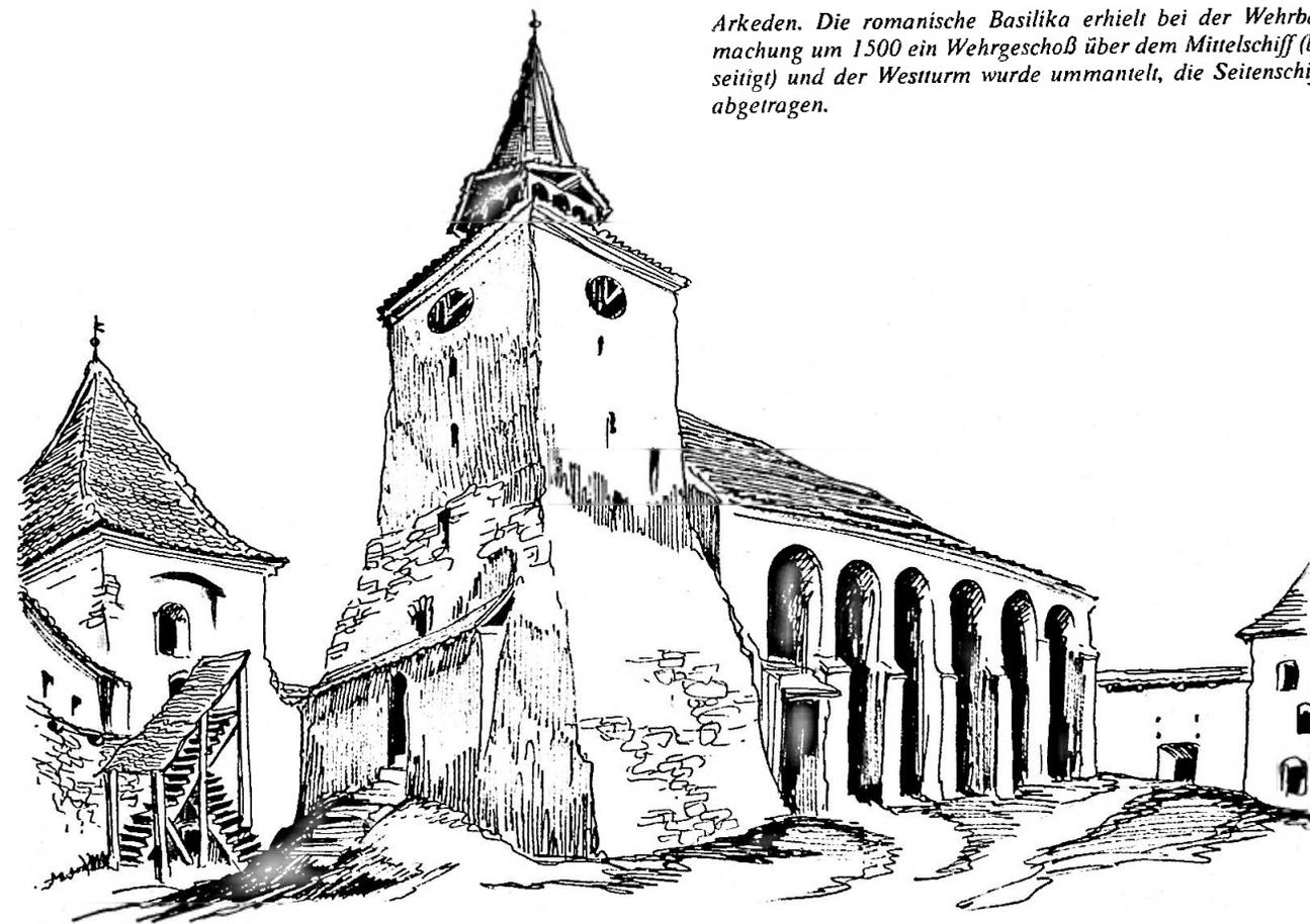
*Arkeden. Die romanische Basilika erhielt bei der Wehrbarmachung um 1500 ein Wehrgeschoß über dem Mittelschiff (beseitigt) und der Westturm wurde ummantelt, die Seitenschiffe abgetragen.*
