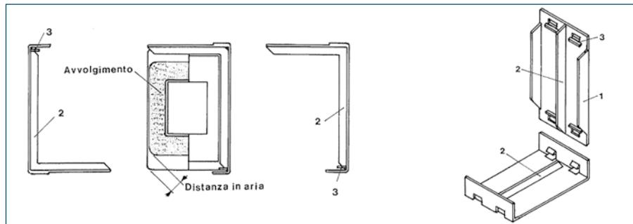
Tutti i nostri rochetti sono dotati di 2/3 nervature interne nel tubo per permettere a chi usa le tradizionali macchine impacchettatrici di poter infilare fino all'ultimo lamierino senza doverlo fare manualmente.
