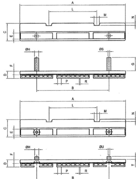
Fissaggio con solo due viti senza dadi
