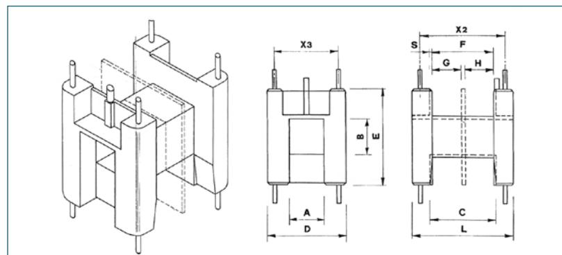
CON MOLLETTA DI BLOCCAGGIO FERRITE
