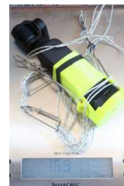
mini nacelle en I3D + demi picavet pliant : cela tient dans un étui à lunettes !
