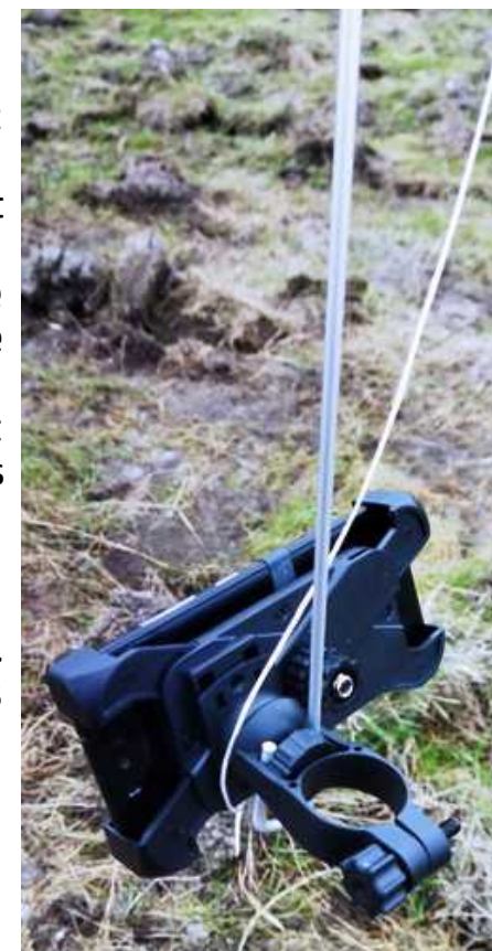
Ici un support vélo adapté à la va vite sur un simple pendule en alu
