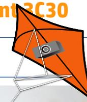
La rotaScoo est un projet de nacelle minimaliste, prévue pour les vents légers et permettant une rotation de l'appareil sans embarquer d'électronique ou de pile.
