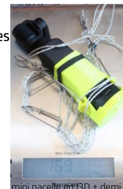
mini nacelle en 13D + demi picavet pliant : cela tient dans un étui à lunettes !
