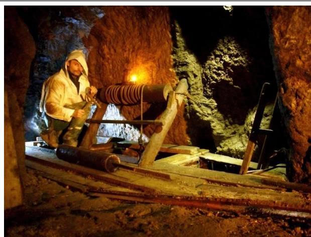
Rekonstruktion eines historischen Haspels, errichtet über einem Tiefbau
