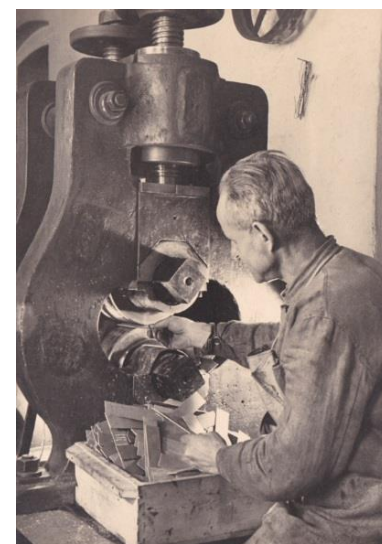
Stanzen der Löffelrohlinge um 1948
