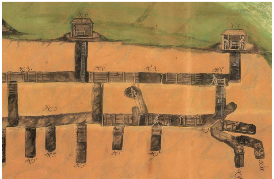
Die Wenzel-Zeche auf einem Ausschnitt aus einer Grubenkarte von 1720 (Quelle: Nationalarchiv, SMMP-Bestand), unten Detail des südlichen Teils der Grube.
