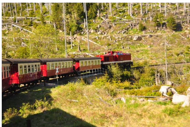
Das „Brockenkamel“, eine in der Spur modifizierte V110, wird aufgrund der Waldbrandgefahr zwischen Drei Annen Hohne und dem Brockengipfel eingesetzt.
