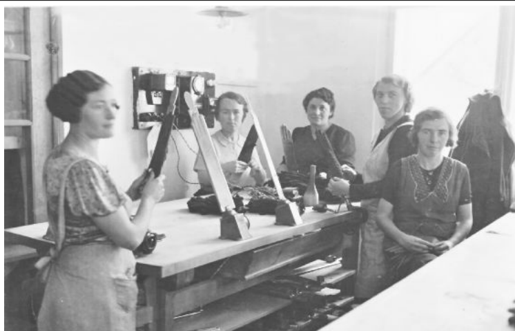
Dressieren, oder auch umgangssprachlich Glätten oder Bügeln, der Handschuhe als letzter Arbeitsschritt vor dem Versand in der Firma Rudolf Geuthner / Abertham
