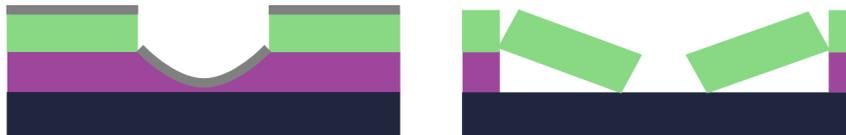
Abbildung 3.8: Mögliche Fehlerquellen bei der Entwicklung eines Doppellacksystems. Links: zu kurze Entwicklung führt zum Ablösen des aufgetragenen Materials; Rechts: zu lange Entwicklung führt zu einem großen Undercut, wodurch die Struktur einstürzen kann)
