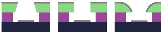
Abbildung 3.9: Unabhängigkeit des Doppellacksystems von der PMMA-Entwicklungszeit
