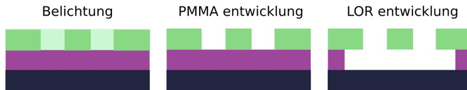
Abbildung 3.10: Herstellung einer freistehenden Nanobrücke durch Unterätzen
