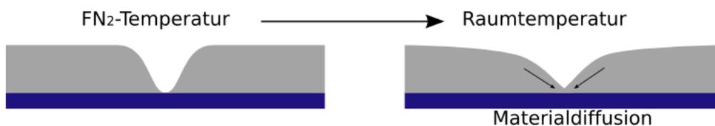
Abbildung 6.21: Healing Effekt durch Diffusion der Ag Atome ins Gap für den Fall, dass eine Benetzung zwischen Ag und Si stattfindet (z.B. durch ein bestehenden wetting layer)
