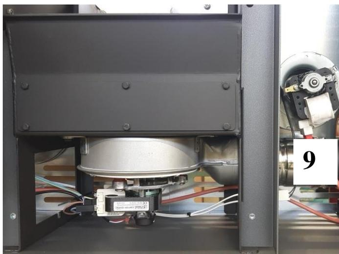
Para aceder há conduta de fumos, desenroscar os parafusos que fecham posteriormente, de forma que se tenha acesso ao interior da estufa.
