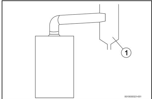
Fig. 13 Recolha de condensados
