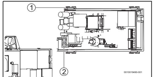
Fig. 27 Substituir o fusível
