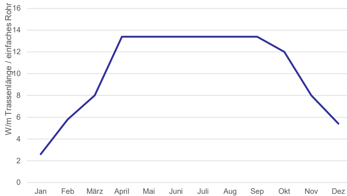
Leistung eines Flächenkollektors innerhalb eines kalten Nahwärmenetzes in W/m im Mittel über 25 Jahre
