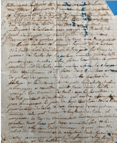
1783, Contrat de construction entre JH Duboys et Rougier, tailleur de pierres, charpentier pour bâtir d'ici la fin de l'été ... une grange de 70 pieds de longueur sur 36 de largeur en dedans de murs de 15 pieds... les murs faits à la chaux et à sable bien conditionnée en tous points... bien couverts de tuiles avec des fermures de 6 portants et des fenêtres... moyennant le prix de 800 livres et 2 livres pour acheter du tabac et deux barques de vin que (JH) lui fournira (archives familiales)
