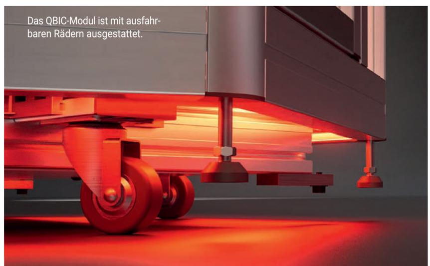
Das QBIC-Modul ist mit ausfahrbaren Rädern ausgestattet.
