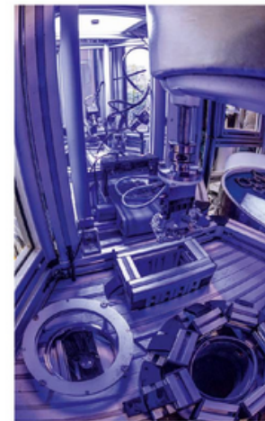
2 Der Roboter erfasst die Teile präzise und präsentiert sie den 2D- und 3D-Visionssystemen, um Maßhaltigkeit und Oberflächenbeschaffenheit zu überprüfen © Cretec
