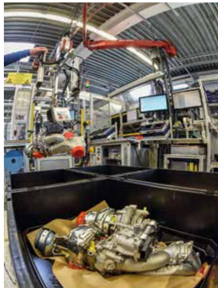
Mit dem Kran werden die Turbolader nach der letzten Montagestation vom Werker in die Trays der 4 Boxen positioniert und abgelegt.
