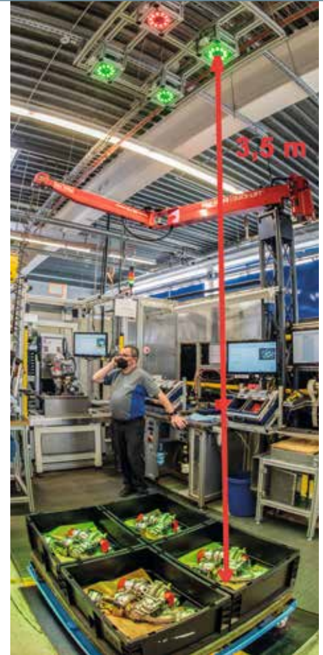
Trotz einem Abstand von 3,5 m liefert die Vision-Applikation feinste Detektion der zu prüfenden Turboaggregate im Tray der Transportbox.
