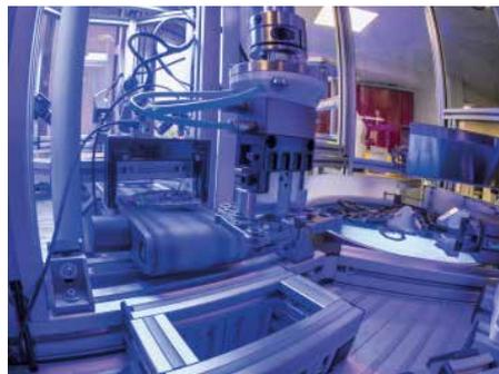
Jedes Bauteil wird vollautomatisch von allen Seiten (360°) auf 21 Prüfmerkmale präzise kontrolliert. Die Daten und Bildern werden dokumentiert und die Teile in IO/NIO sortiert.
