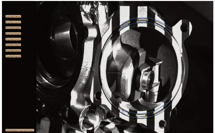
Bild 2 | Z-Ring Kontrolle des Turboaggregats auf Anwesenheit und 3D-Höhe mittels eines LED-Projektors und einer 20MP-Zoomkamera.
