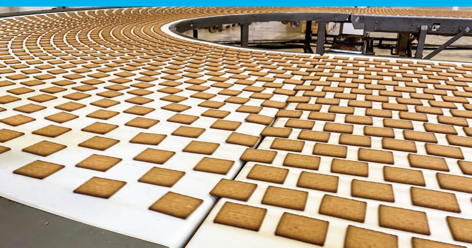
Bild 1 | 4.200 Kekse pro Minute müssen bei der Produktion auf über 20 Merkmale sehr präzise detektiert und in IO/NIO getrennt werden. Viele Ergebnisse werden als Datenstrom direkt genutzt, in der Rückkopplung auf den laufenden Produktionsprozess.
