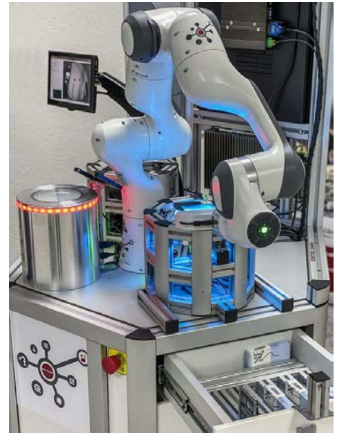
Das modulare QBIC-System kann – als universelle, sehr flexible Arbeitsplattform – viele unterschiedliche Prüfaufgaben auf minimalem Raum vollautomatisch erledigen. (Foto: Cretec)
