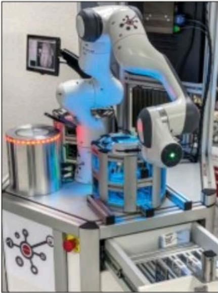
Die QBIC-Station von Cretec erschließt in der Mensch-Roboter-Kooperation auf Basis einer Industrie-4.0-Plattform mit dem hochskalierbaren IOTA-Kommunikationsprotokoll neue Vision-Lösungen in Fertigungs- und Geschäftsmodellen. Die sensitiven Cobots können ohne aufwendige Schutzvorrichtungen direkt mit dem Mensch kooperieren. Die feinfühlig Sensorik erreicht hohe Sicherheitsstandards in der Kollisions-
