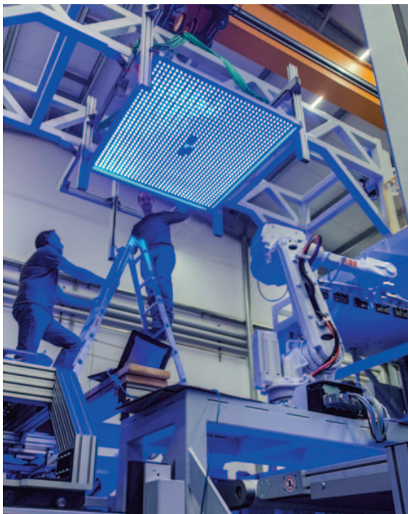
Das homogene Licht einer 1.500x1.500mm großen LED-Beleuchtung sorgt für die Kontrolle des Kleberauftrages einer Automobil-Hutablage mit einer sicheren Detektionsauflösung von 0,3mm.
