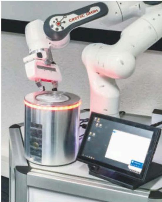
Die exakte Verifikation erfolgt in der Datenvalidierung konform zu allen gängigen internationalen Normen von 1D- (ISO 15416) und 2D-Codes (ISO 15415, ISO 29158, AIM/DPM). (© Cretec)
