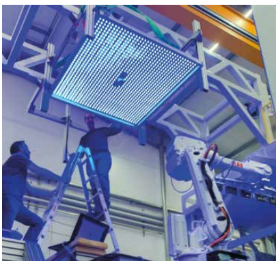
Das homogene Licht einer 1.500 x 1.500 mm großen LED-Beleuchtung ist der Garant für die präzise Kontrolle des Kleberauftrages einer Automobil-Hutablage mit einer sicheren Detektions-Auflösung von 0,3 mm.
