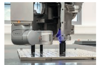
Erweitert den Funktionsumfang eines Koordinatenmessgeräts um die Geschwindigkeit und große Messbereiche des Laserscannings
