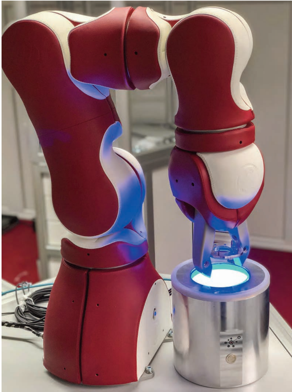
Bild 4 | Der Einsatz des VisionTube ist auch in vollautomatisch gesteuerten Fertigungszellen oder in Kombination mit einem kollaborativem Roboter möglich.
