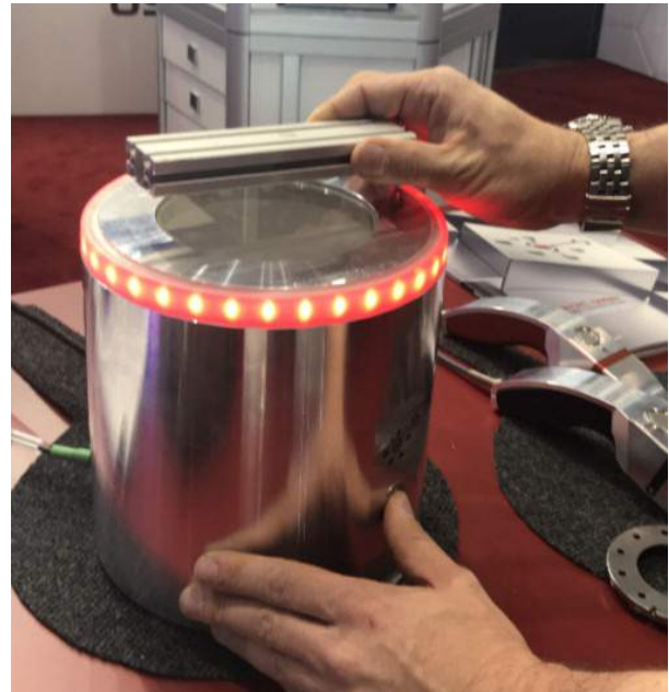
Bild 4 | Eine normgerechte Code-Verifikation mit Autofokus ermöglicht die VeriTube von Cretec.
