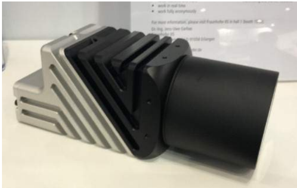
Bild 3 | Die auf einer Linux Open Source Plattform basierende AX-Kamera von Baumer hat eine High-Performance GPU von Nvidia (Jetson TK1/Tx2) integriert.
