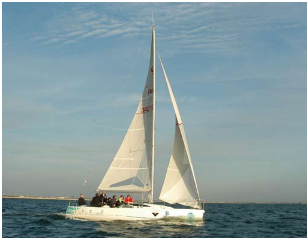
Bateau de régate de 10 m réalisé par collage structural.
