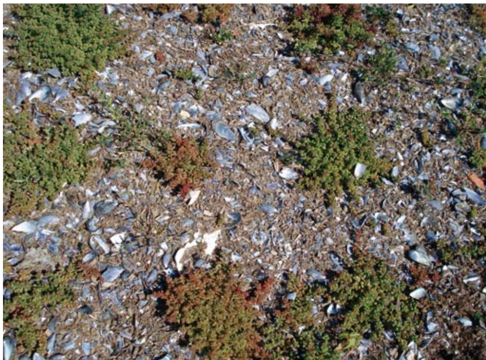
Étude d'un substrat de cultures pour toitures végétalisées à base de coquilles de moules et d'huîtres.
