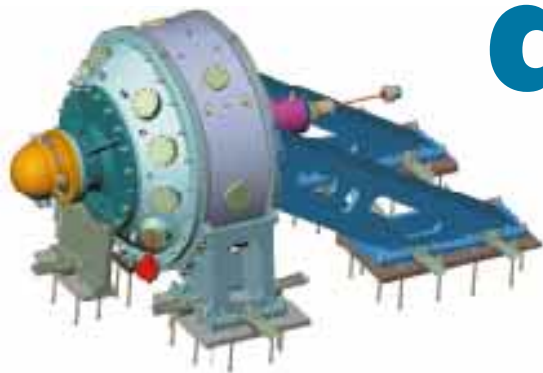
Ci-contre : illustration du banc Balafre qui pourra simuler des vibrations de 20 à 200 Hz.
