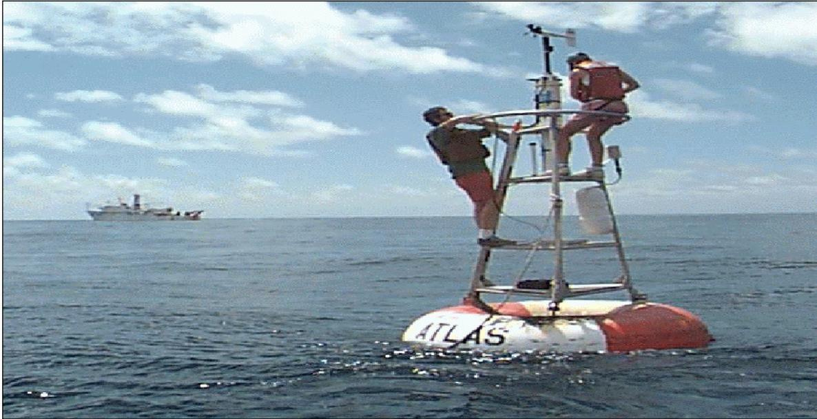
**Figure 39 : Opération de maintenance d'une bouée ATLAS**
